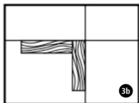
5. Placez la lamelle #2 (tenon à gauche) à angle droit avec la lamelle #1 (tenon à droite) de façon à former une "flèche" (illustration 4a et 4b) pointant dans la bonne direction. La mise en place des lamelles sur tout le plancher sera identique.
